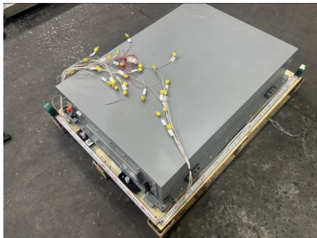
Zdjęcie modułu akumulatorowego 1P52S/280Ah-0.5P
